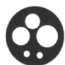
•Connexion Midwest 5 trous type américain avec ampoule dans le connecteur
