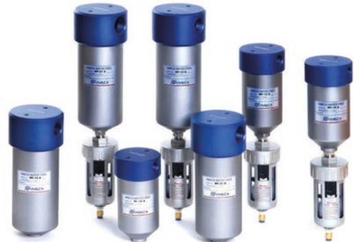
Le water-free est un assécheur à effet cyclone sans pièce en mouvement et sans câblage électronique. Il prévient des problèmes de condensation de point de rosée de l'air, lors des différences de températures. Il ne remplace pas les assécheurs sortie de compresseur mais les complète, pour assurer un air parfaitement sec à 99,99% directement à l'endroit désiré. L'eau est récupérée dans l'auto-drain qui se vidangera automatiquement.
